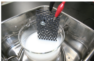
不溶性電極を用いた抗生物質の無害化
