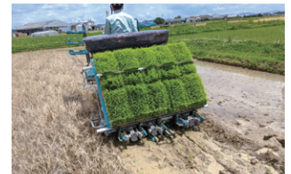
不耕起田植機への改造と水田での移植実験(附属食資源教育研究センター)
