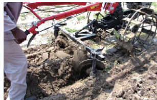
1行程での畝立機の試作とトウジンビエ・ササゲ畑での実験(ナミビア大学)
