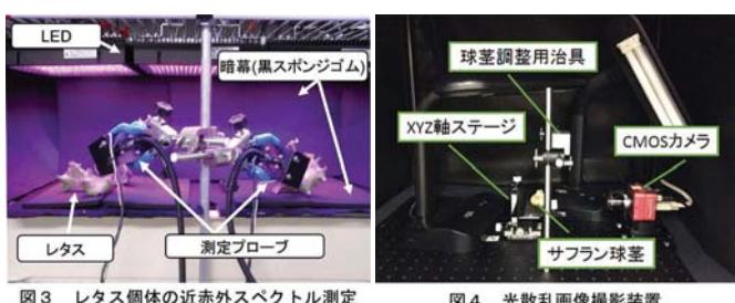
図3 レタス個体の近赤外スペクトル測定
